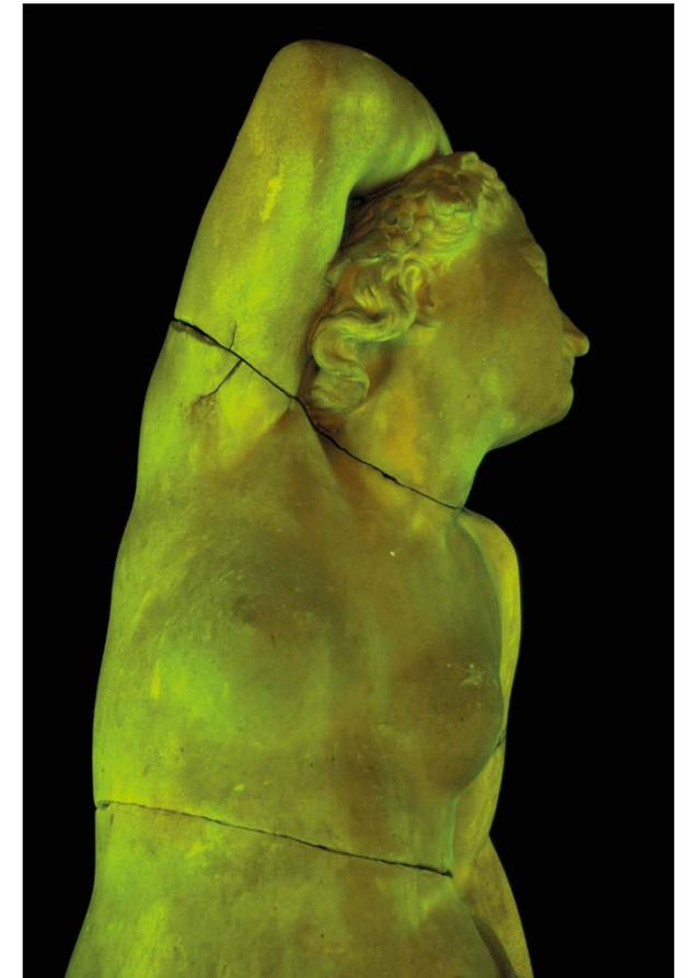
Imagen de fluorescencia inducida por radiación UV. Se observan las alteraciones irregulares en la superficie del mármol. Fotografía: Archivo CNCR (Rivas, V. 2013)
